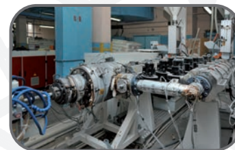
Екструдерна лінія формування фільєра
