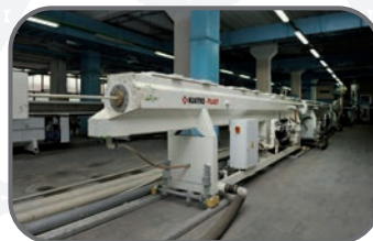
Охолоджувальний блок екструдерної лінії
